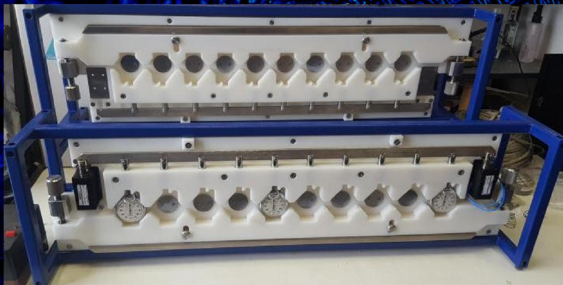
Устройство автоматического пуска и останова секундомеров
