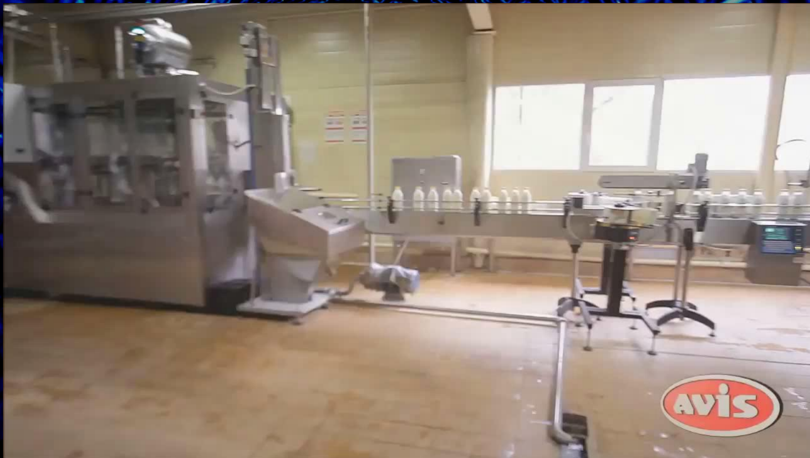
Линия розлива жидких продуктов в ПЭТ-тару (совместно с НПО «Компания АВИС»)
